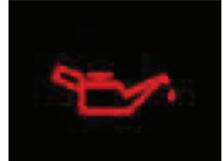
è necessario sostituire l'olio? Oltre a controllare la quantità di olio dovete anche verificarne la qualità. L'olio deve apparire chiaro e pulito. Se invece sembra contenere detriti o risulta torbido deve essere cambiato. La frequenza con cui dovrete sostituire l'olio dipende dal tipo di vettura. Alcune automobili avranno bisogno un cambio d'olio ogni 5000 chilometri, mentre altre potranno andare avanti fino a 15000 o addirittura 25000 chilometri senza alcun cambio.
